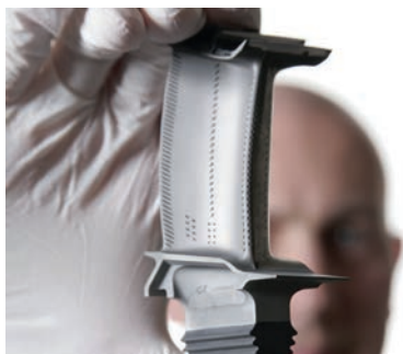
Figura X3. Orificios para refrigeración y recubrimientos térmicos en un moderno álabes de turbina
